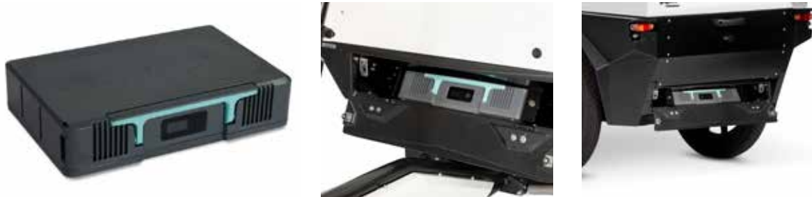
Figuur 12: Locatie van de twee LiFePO 4 accu's. Eén aan de voorkant en één aan de achterkant van de fiets.
